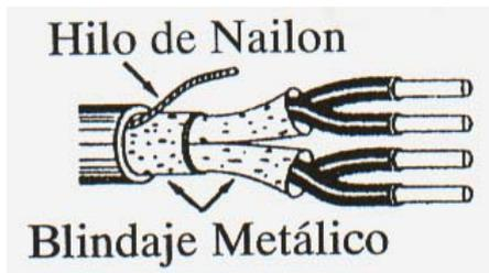
Este tipo de cable está formado por grupos de dos conductores cada uno con su propio aislante trenzados entre sí y rodeados de una pantalla de material conductor, recubierta a su vez por un aislante. Cada grupo se trenza con los demás que forman el cable y, el conjunto total se rodea de una malla conductora y una capa de aislante protector. Esta
