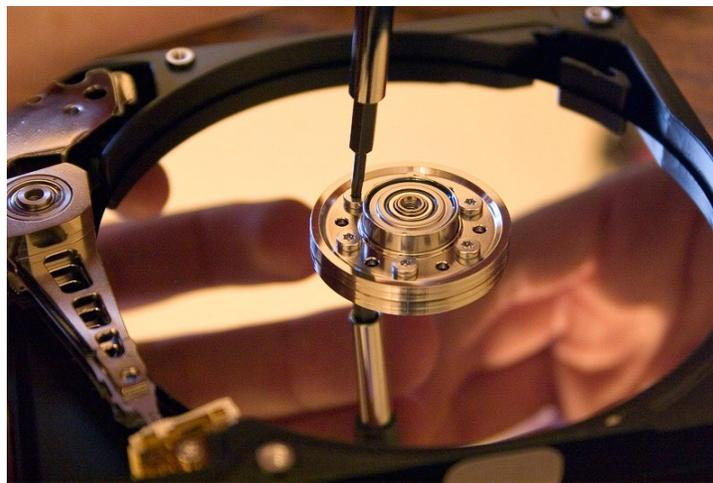
Se compone de uno o más platos o discos rígidos, unidos por un mismo eje que gira a gran velocidad dentro de una caja metálica sellada. Sobre cada plato, y en cada una de sus caras, se sitúa un cabezal de lectura/escritura que flota sobre una delgada lámina de aire generada por la rotación de los discos. A nivel lógico, se debe inicialmente crear una o más particiones con un formato de bajo nivel por medio de un sistema operativo para poder utilizar un disco duro.
