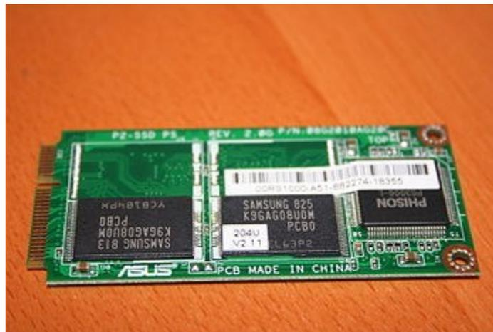
Con respecto al diseño, arquitectura y funcionamiento de las SSD se distinguen dos periodos: uno con la memoria volátil DRAM, y el más notable, la fabricación por medio de una memoria no volátil NAND
